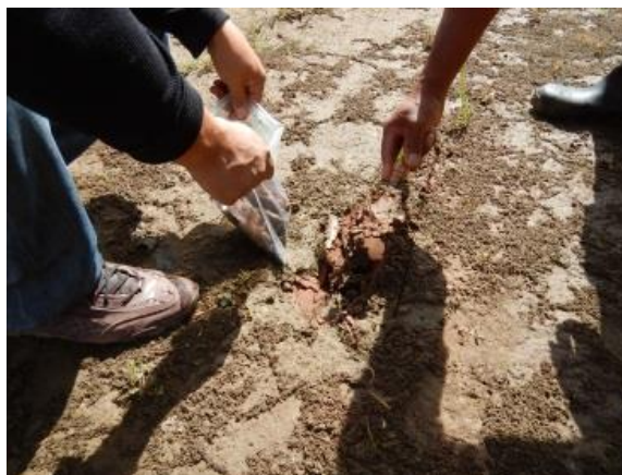
Foto 14. Río Tumusla (Palca Grande)-Muestreo de sedimentos de la llanura de inundación
