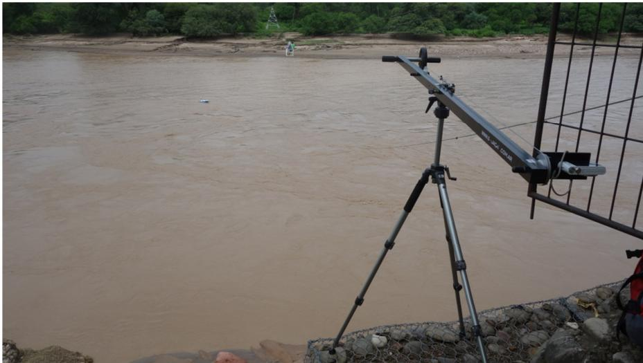
Figura 4: Configuración del sistema para la implementación de la técnica de PIV. La cámara digital montada sobre una grúa desde la margen izquierda del río
