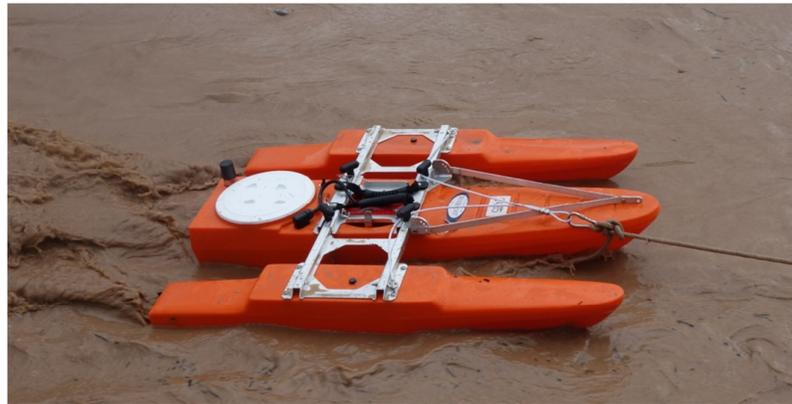
Figura 3: Perfilador de Corriente Acústico Doppler (ADCP) “Workhorse Río Grande” y Plataforma móvil.
